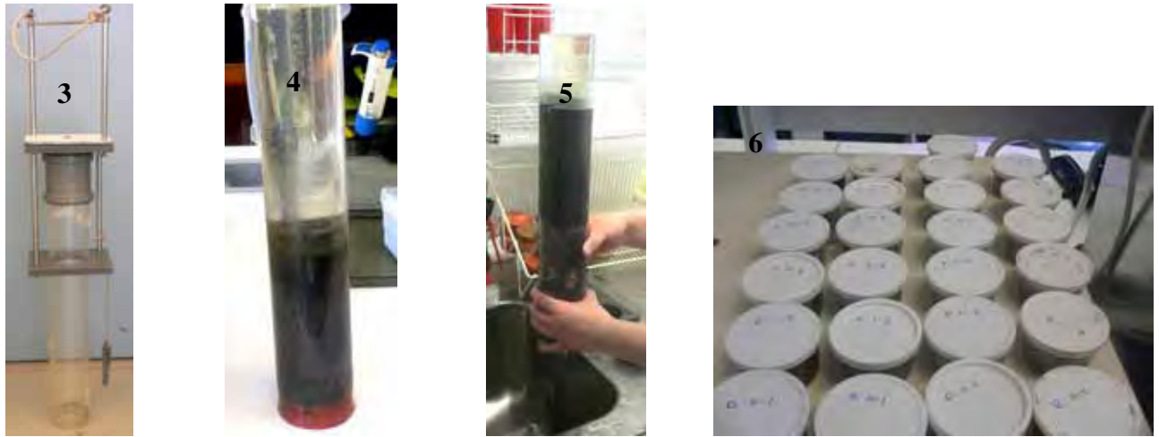
Fig. 3- 6. Figur 3 och 4 visar hur rörhämtaren och sedimentpropparna såg ut. Figurerna 5 och 6 visar skitningen och uppdelningen av proven.
